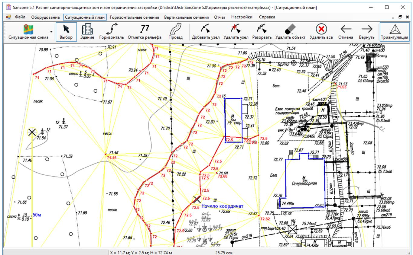
Рисунок 13. Ввод информации о рельефе местности на ситуационном плане (желтым цветом показаны триангуляционные треугольники)
