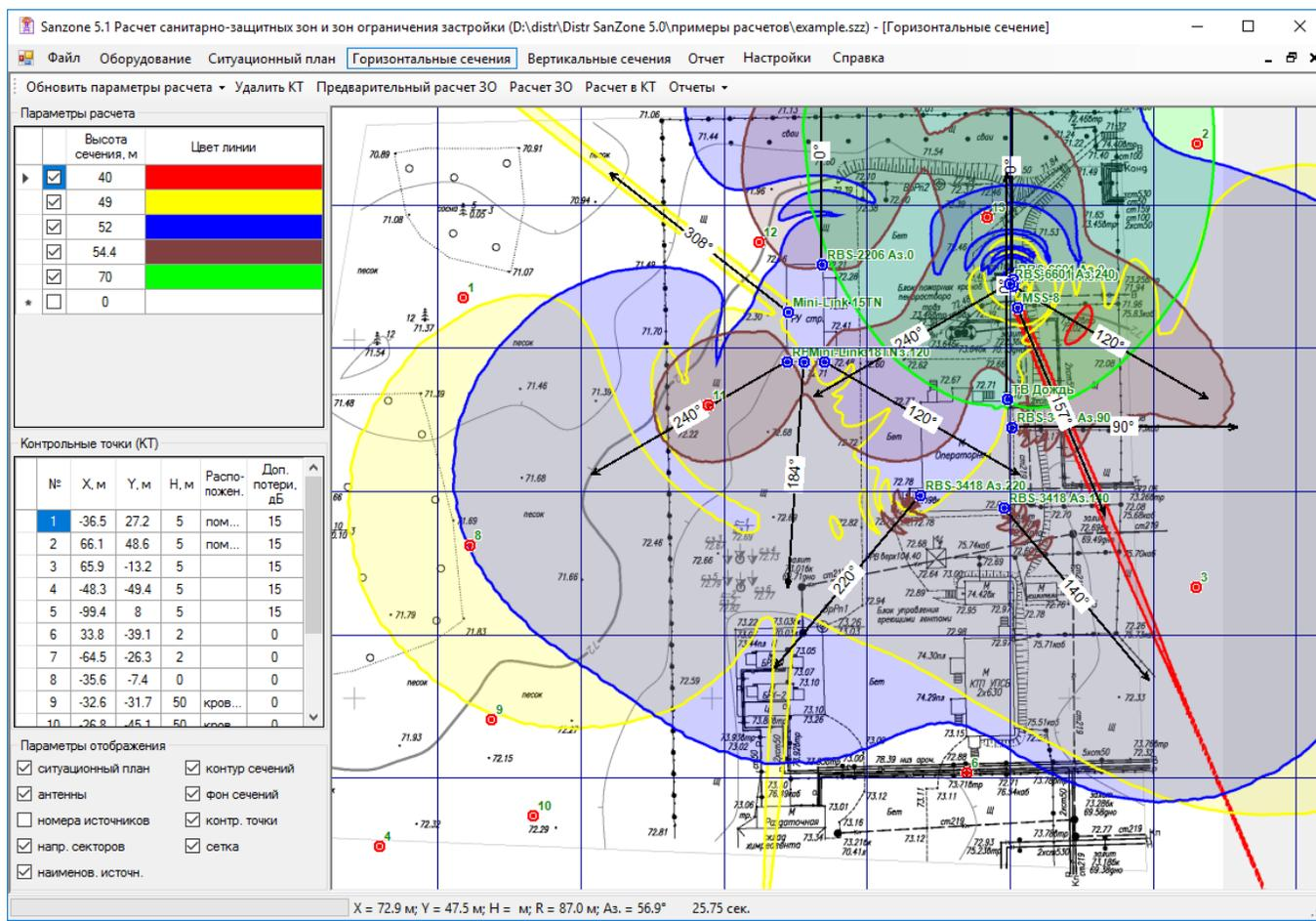
Рисунок 16. Результат расчета в горизонтальных сечениях, когда каждое сечение показано своим цветом
