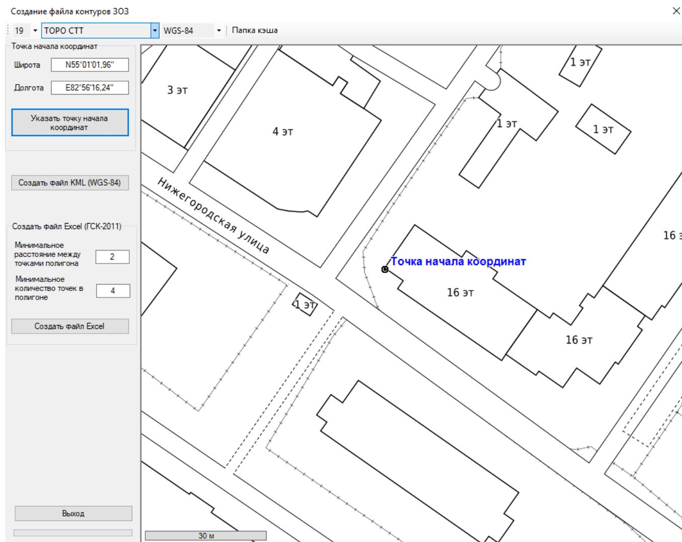
Рисунок 21. Привязка точки начала координат к географическим координатам
