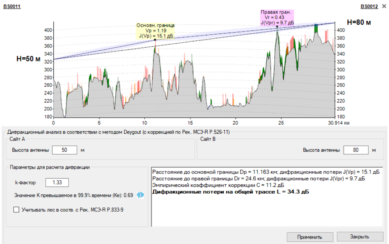
Рисунок 23. Анализ дифракционных потерь по методу Дегу по Рек. МСЭ-R P.526-11
