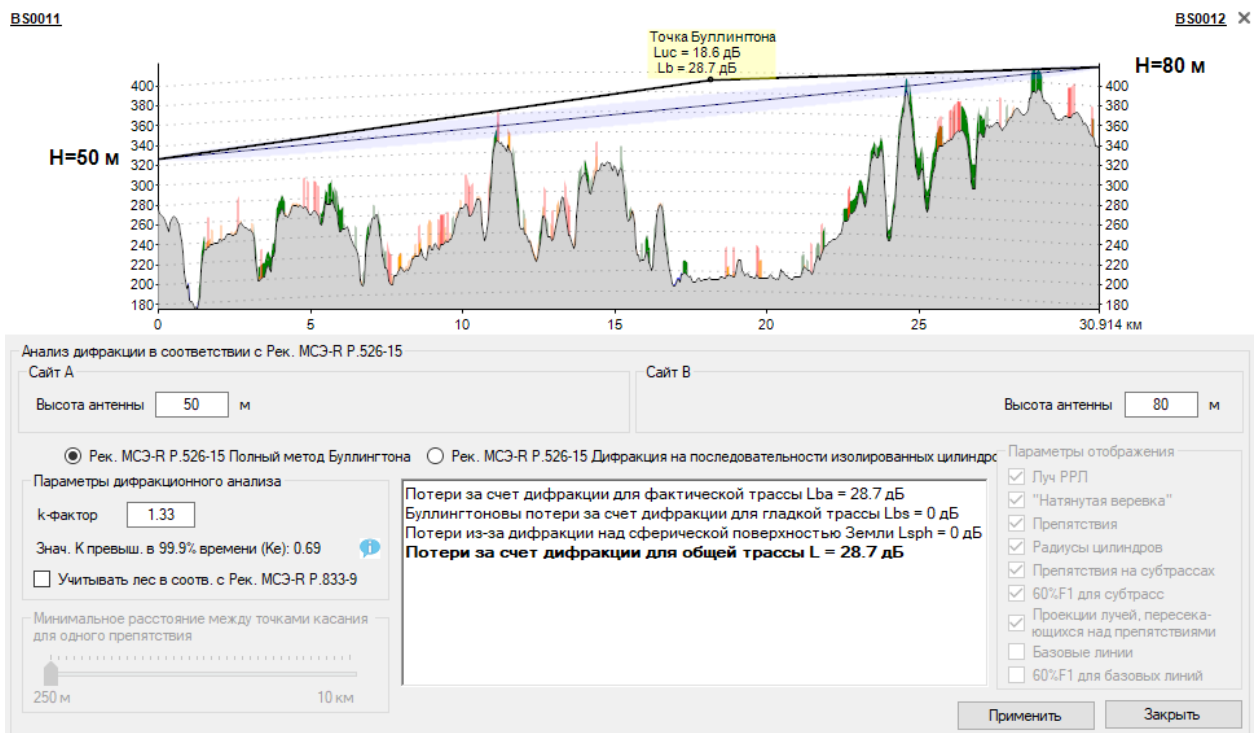
Рисунок 21. Анализ дифракционных потерь на интервале по Полному методу Буллингтона по Рек. МСЭ-R P.526-15
